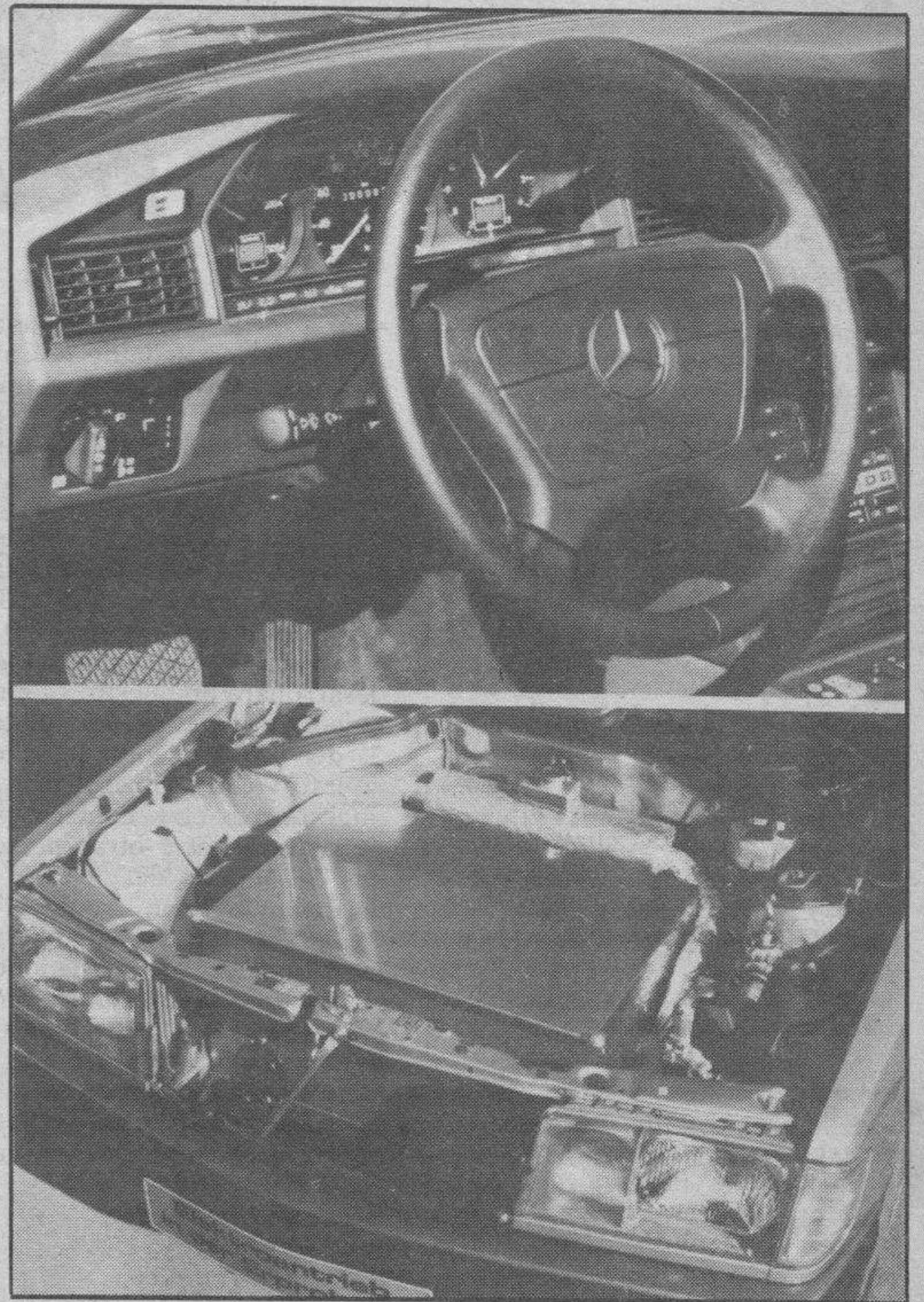
Una batería se aloja en el lugar del motor diesel. (Foto: DB)
