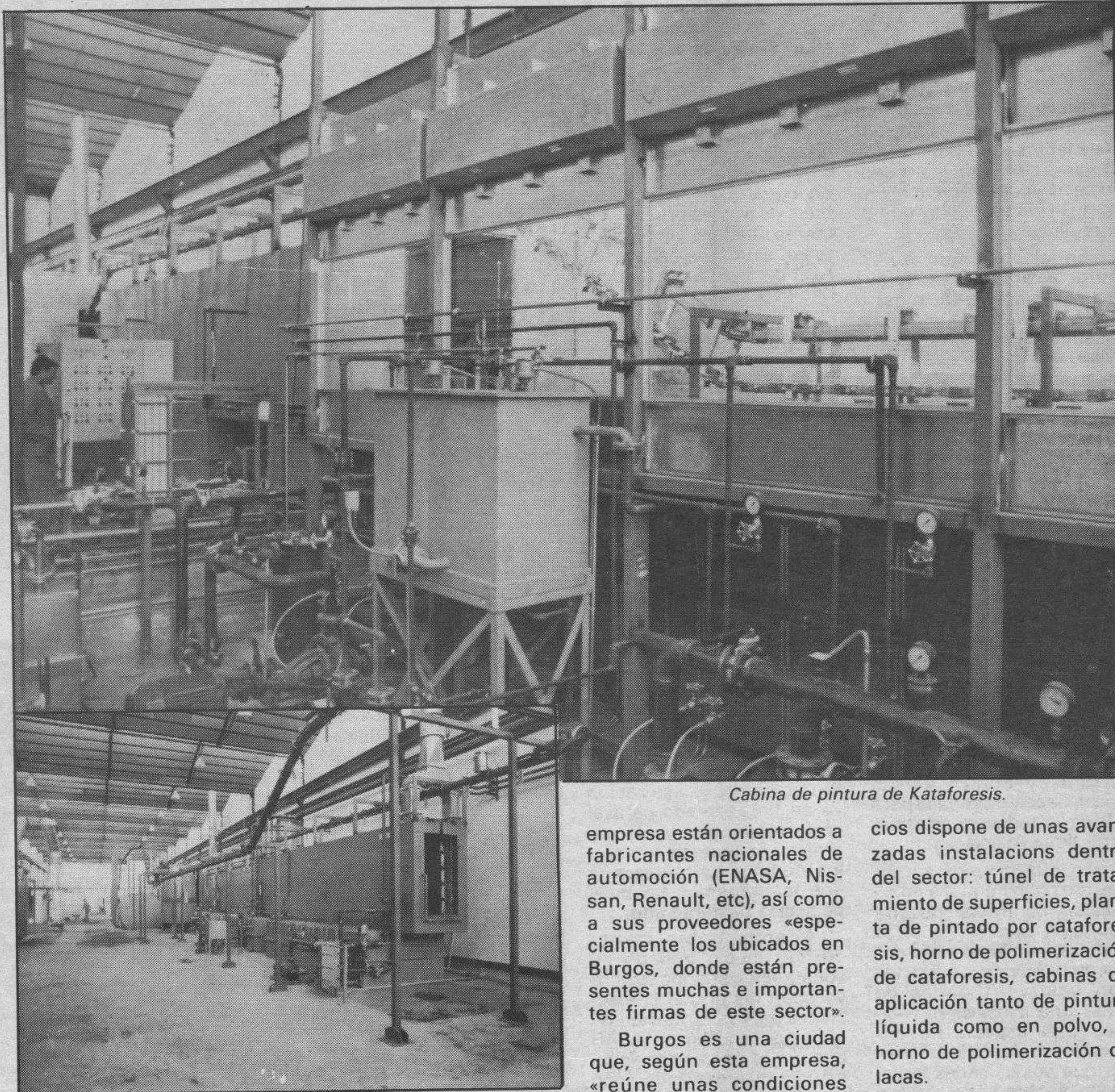
Vista general de la línea de Kataforesis de «KDB»: túnel de tratamiento.
