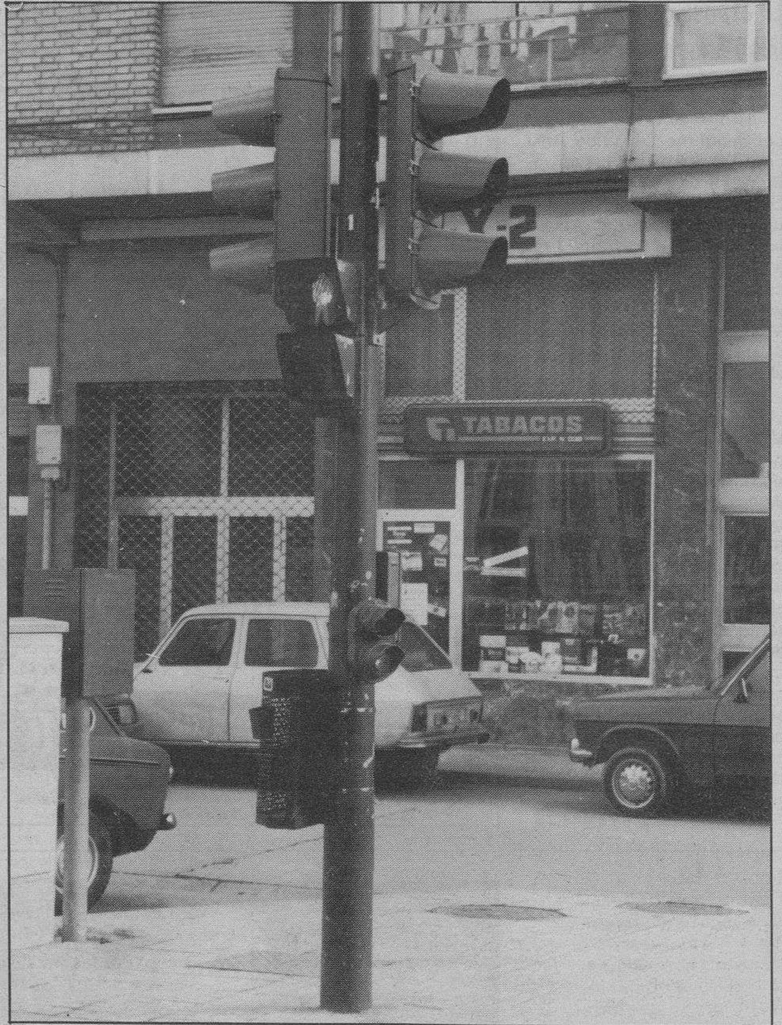
Todo en una pieza.- Aprovechamiento de espacio y de recursos, es lo que se da en esta ocasión. La «foto» muestra una farola -que no se puede ver completa para apreciar otros detalles- que además de ser eso, farola, alberga dos semáforos completos, pulsador para los peatones que quieren cruzar la calzada y una papelera.
