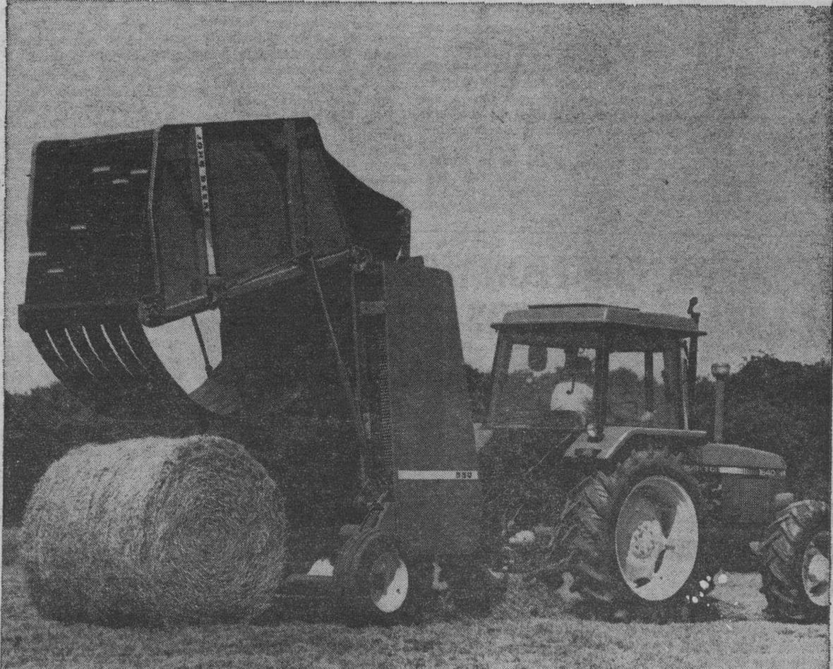
**Nueva, rápida y sencilla: La empacadora 550 de John Deere forma capas cilíndricas de gran densidad, con heno o paja, cualesquiera que sean las condiciones atmosféricas.**
