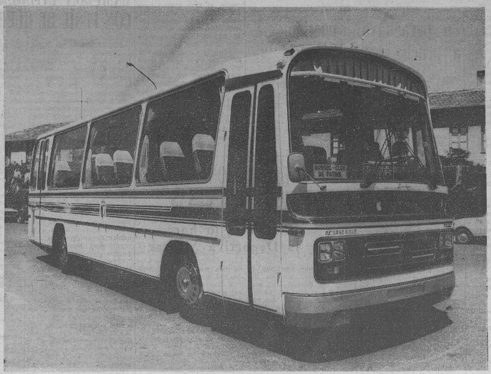
PEGASO modelo 6046/2 de 200 HP, suspensión neumática, equipado con aire acondicionado Carrozado por CARROCERIAS MAISO, S. A., de Logroño
