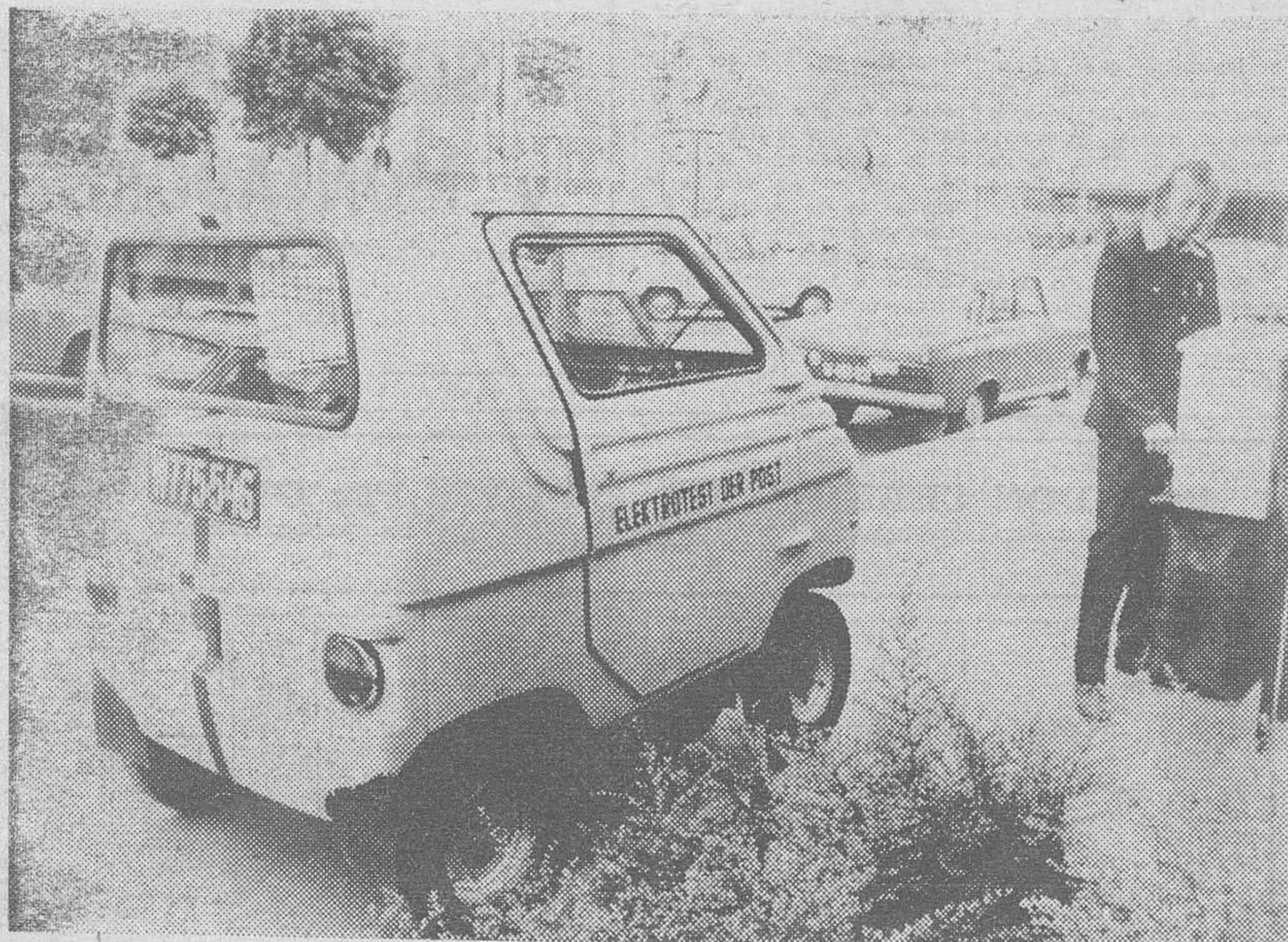
La Administración de Correos de Austria está probando actualmente un coche eléctrico para la recogida y distribución del correo en Viena. El vehículo, un "Zagato Zele 1.000", tiene 4,8 HP. y una velocidad máxima de 50 Kms. hora. — (Foto FIEL).
