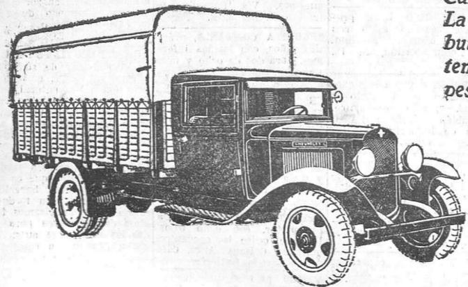
Carrocería tipo militar. La armazón de acero embutido es sumamente resistente sin inútil aumento del peso muerto.
