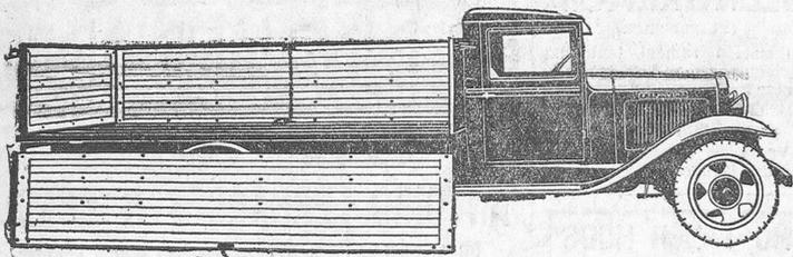
Carrocería de caja con costeros abatibles. Se ofrece en dos modelos con costeros de 80 ó 60 centímetros de alto, y con o sin toldo.
