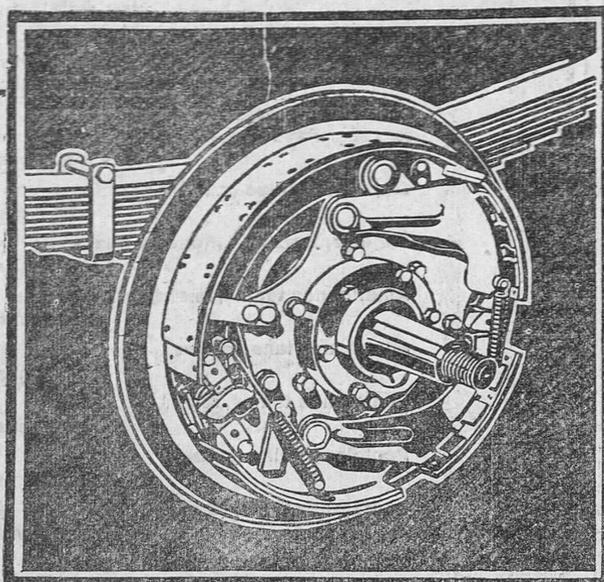
Sección de un freno delantero
