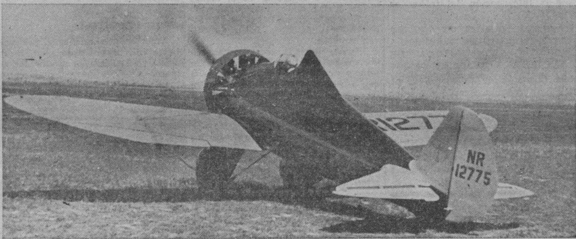
En Barajas se está probando este tipo de avión de caza, americano, de 600 HP. y 400 kilómetros de velocidad, armado con dos ametralladoras sincronizadas con el motor para tirar a través de la hélice.
