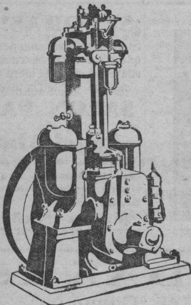
Motores Diesel a cuatro tiempos "REFORM"
