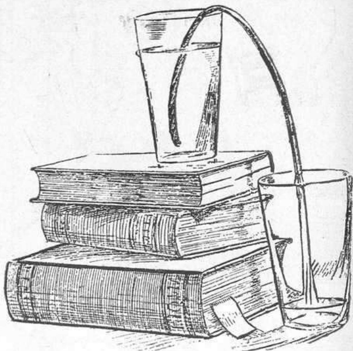
4. Agua pasando de un vaso á otro por el sifón de goma.
