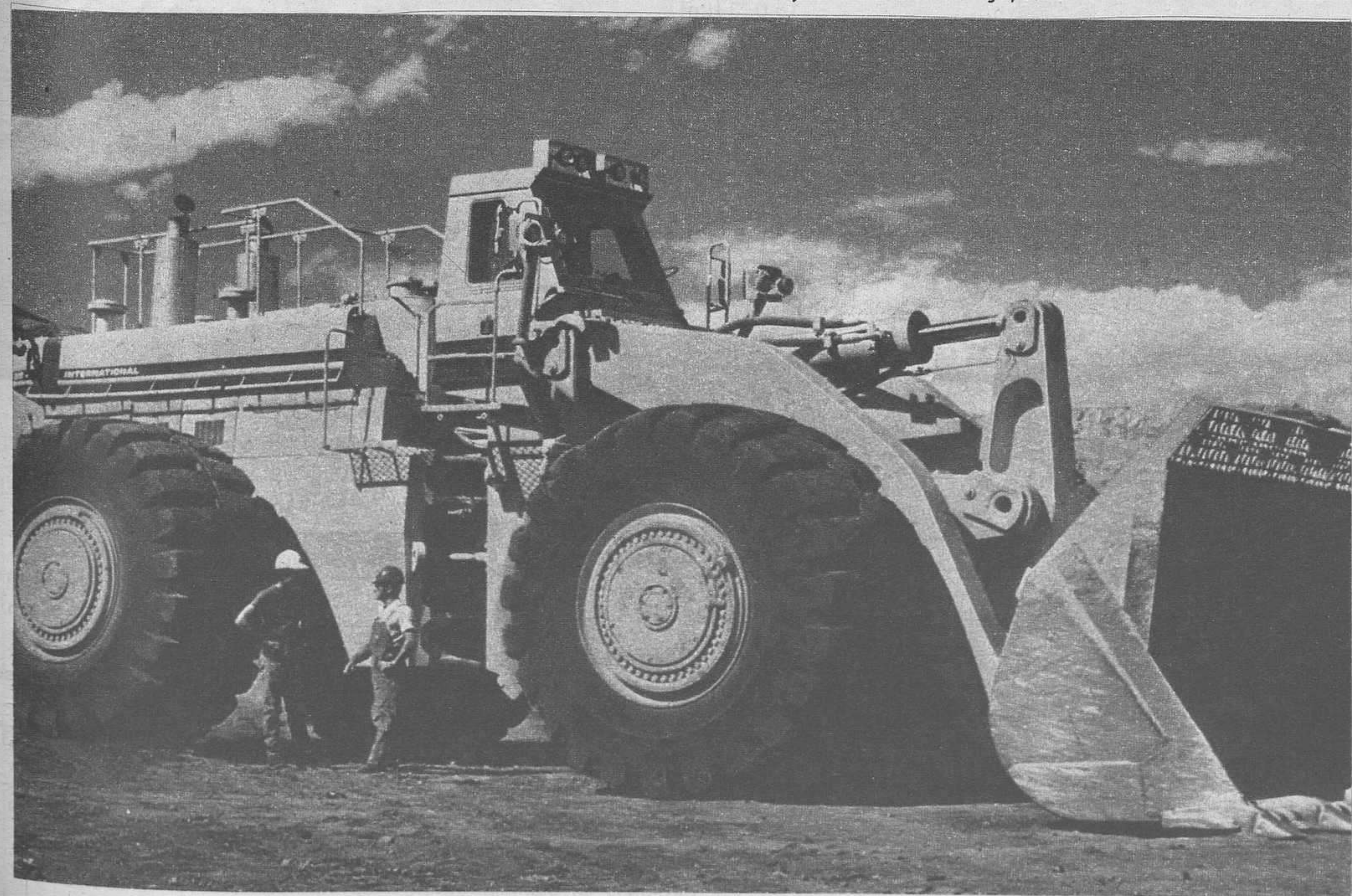
La mayor pala cargadora del mundo, de transmisiones mecánica y de un sólo motor
