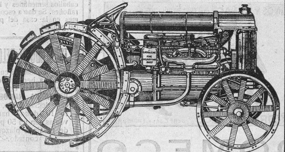
EL TRACTOR FORDSON, labra media hectárea en DOS HORAS, a una profundidad de **22|25** centímetros, gastando **6** litros de gasolina por hora o sean 4,50 pesetas. Con arado de una reja profunda 45 centímetros.
