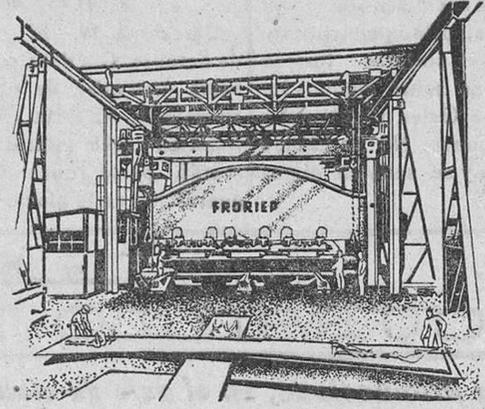
para curvar planchas de hierro para construcciones navales, fué construida por la casa FRORIEP / RHEIDT. Este coloso pesa 720.000 Kg. y con una presión del rodillo de 5.000 toneladas, es capaz de curvar en frío, completamente, planchas de 12.500 mm. de ancho y de 50 mm. de espesor.
