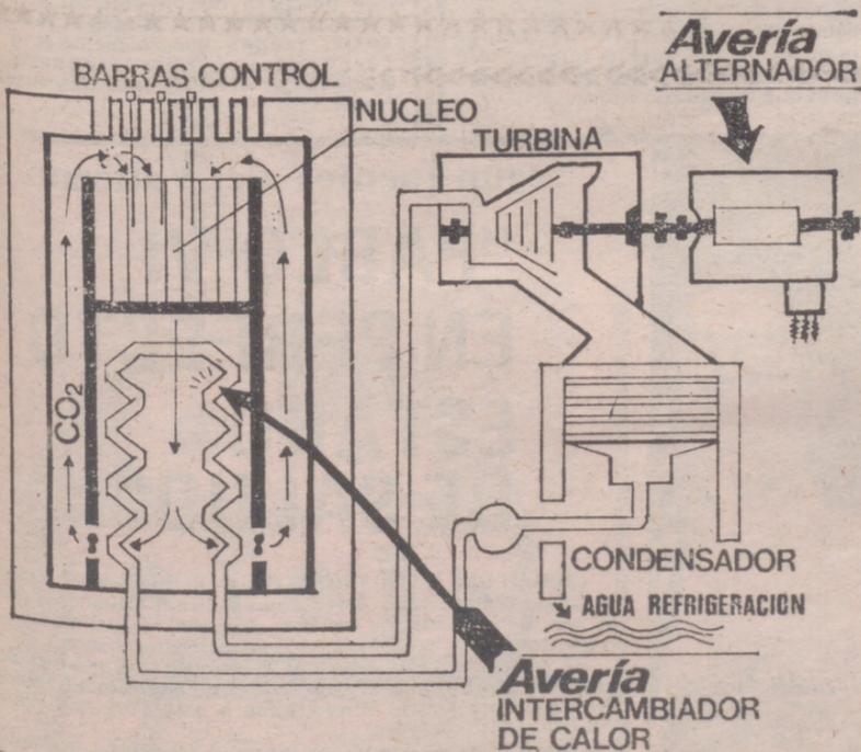
El gráfico muestra un esquema del reactor gráfito-gas de Vandellós y la localización de las averías, reconocidas por "Hifrensa", detectadas en los últimos meses. Sus efectos —según los técnicos de la empresa— no repercuten a la seguridad nuclear.
