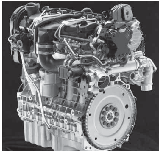
Estructura del nuevo motor diesel 5 cil.
