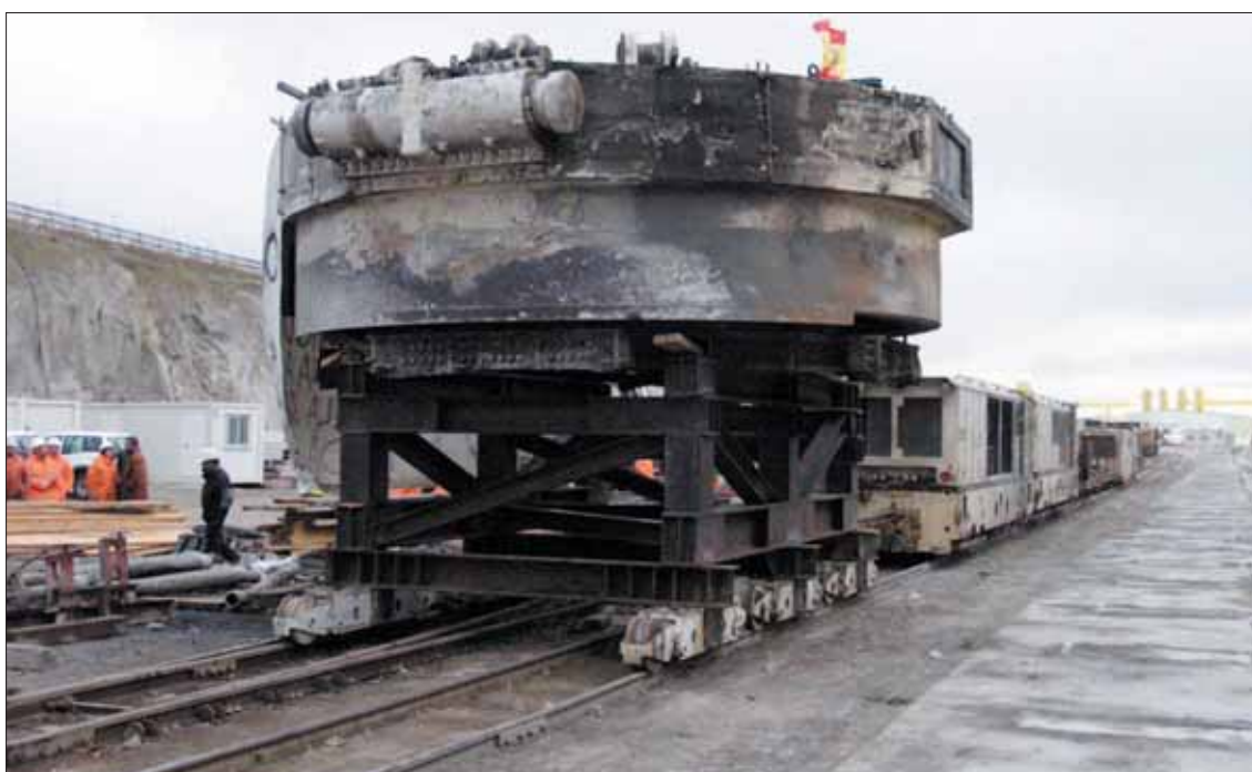
El peso de la pieza de más volumen se sitúa en 140 toneladas, en la foto, en el momento de ser trasladada al exterior
