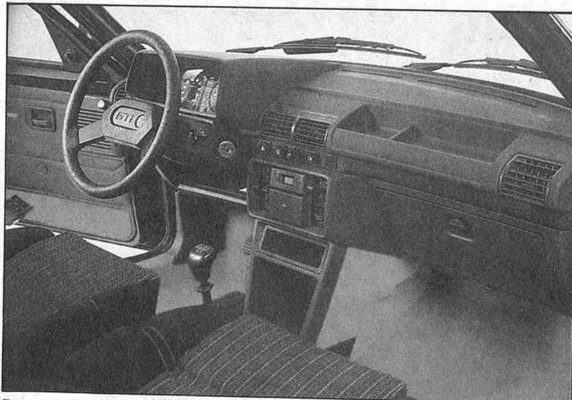
Puesto de conducción del Peugeot 205 GTI, en el que se aprecia el volante de reducido tamaño y su completo cuadro de instrumentación.
