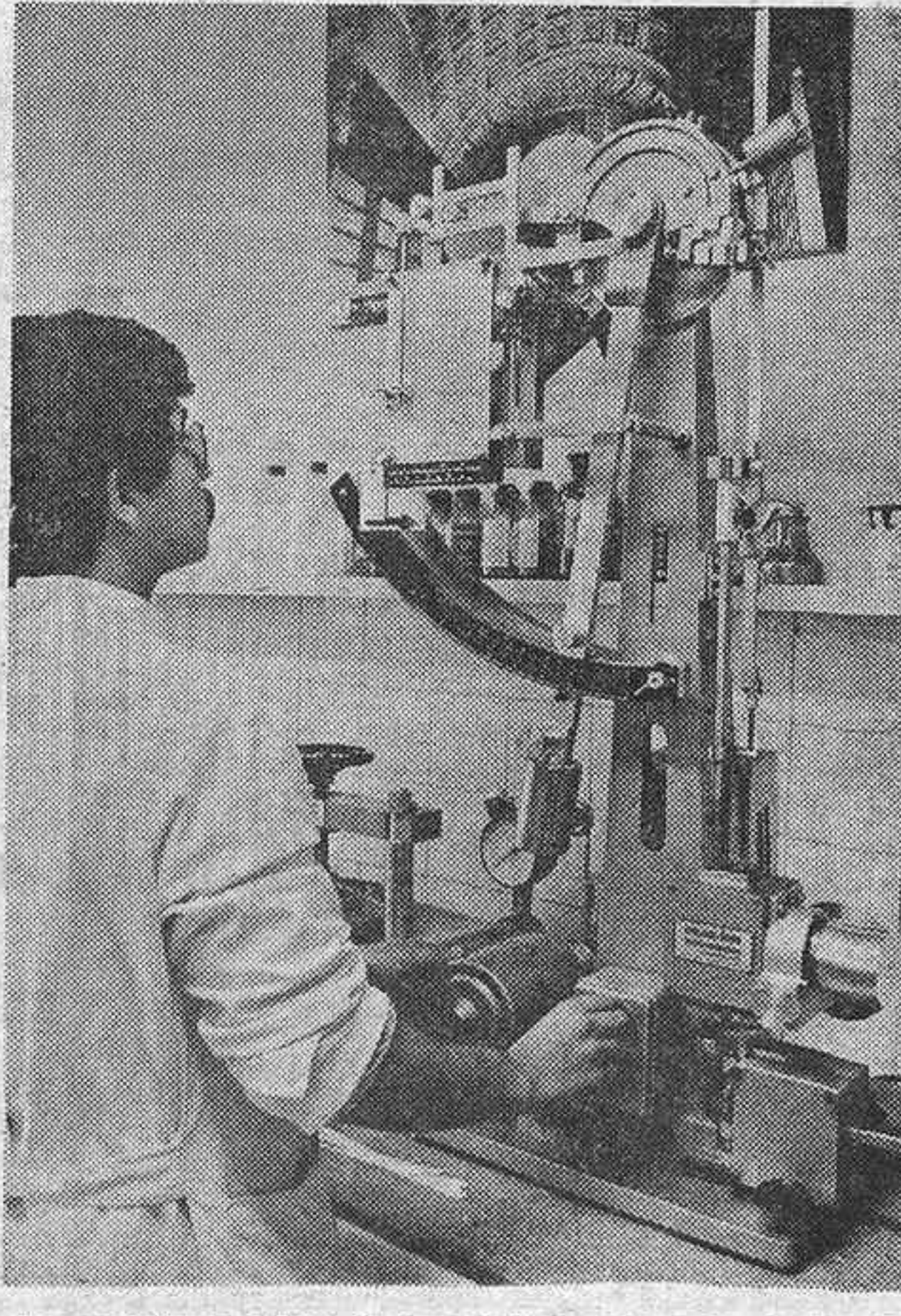
Los aparatos medidores de la resistencia del papel a la tracción y flexión resultan imprescindibles. (Foto Torre-mocho.)
