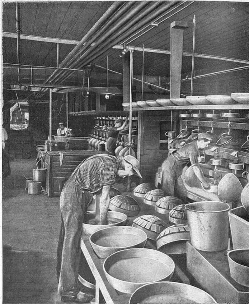
Fig. 3. - Máquina que pule simultáneamente centenares de lentes
