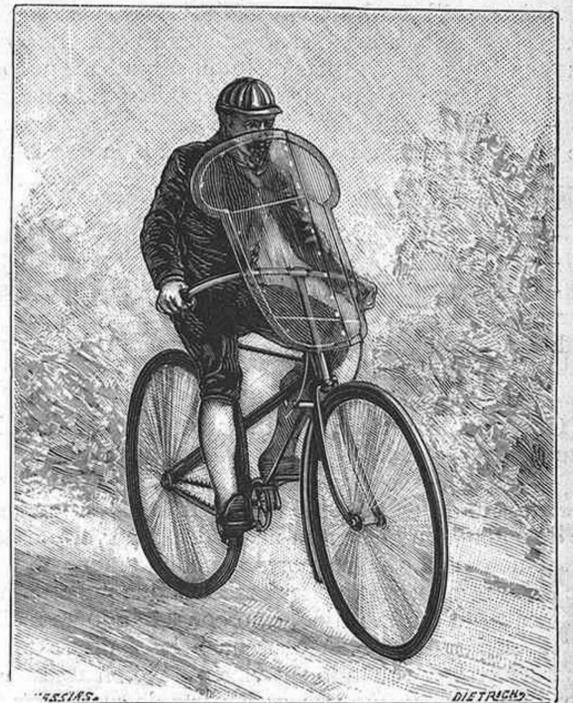
Fig. 2. Aparato cortaviento en marcha
