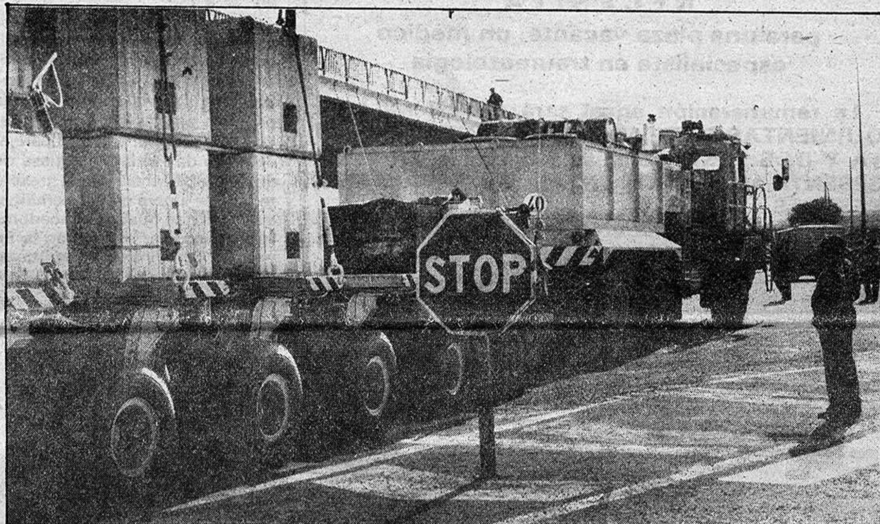
El convoy ya pasó por Guadalajara en viaje de prueba. La longitud y el peso son ahora lo mismo: 56 metros y más de seiscientos toneladas.
