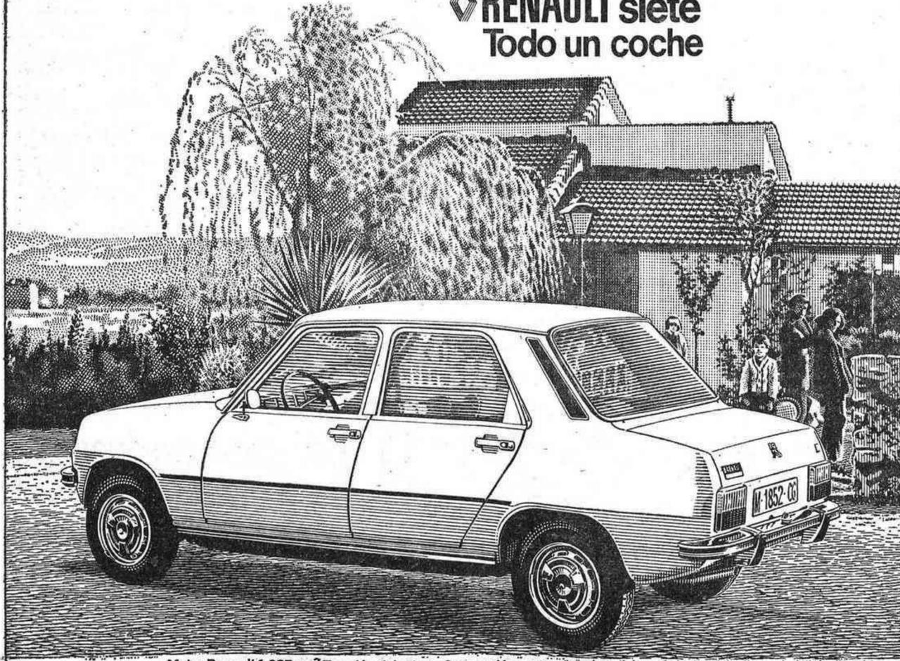
Motor Renault 1.037 cm³ Tracción delantera. Suspensión por barras de torsión. Cuatro puertas.
