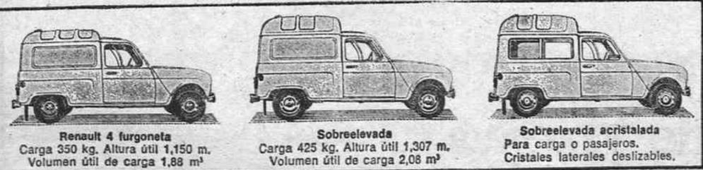
Renault 4 furgoneta Carga 350 kg. Altura útil 1,150 m. Volumen útil de carga 1,88 m<sup>3</sup>. Sobreelevada Carga 425 kg. Altura útil 1,307 m. Volumen útil de carga 2,08 m<sup>3</sup>. Sobreelevada acristalada Para carga o pasajeros. Cristales laterales deslizables.
