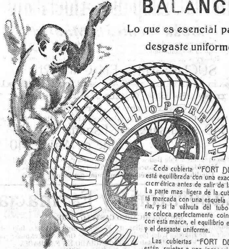
Cada cubierta "FORT DUNLOP" está equilibrada con una exactitud micrométrica antes de salir de la fábrica. La parte más ligera de la cubierta está marcada con una esquila indicadora, y si la válvula del tubo interior se coloca perfectamente coincidiendo con esta marca, el equilibrio es exacto y el desgaste uniforme.
