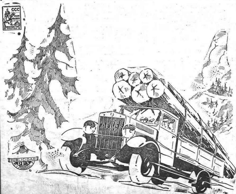
Cigüeñal montado sobre sicor, siete grupos cilindros al níquelcromo, frenos independientes, embrague a cuatro discos conducidos. Potencia del motor al freno, 42 HP. Potencia Fiscal, 17 HP. Largo del bastidor, 4'64 m. Espacio para la carrocería, 3'38 m. Gomas sencillas posteriores, 32x6. Rueda de disco. Completamente equipado con guardabarros anterior y posterior, estribos, faldilla, portaruedas.
