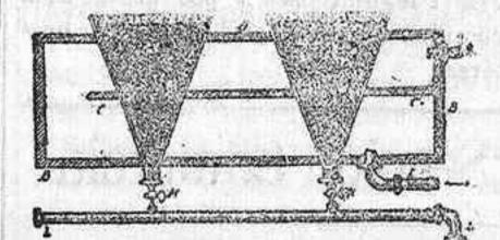
los cenos A; colocados en una caja BB, dividida en dos compartimientos por la pantalla C. Por esta caja circula agua que llega por D y sale por E de modo que el agua más fría se encuentra en contacto con la parte más ancha de les moldes A, con el objeto de que el enfriamiento sea más regular. El ácido fénico situado en A, cristaliza en dos ó tres dias.
