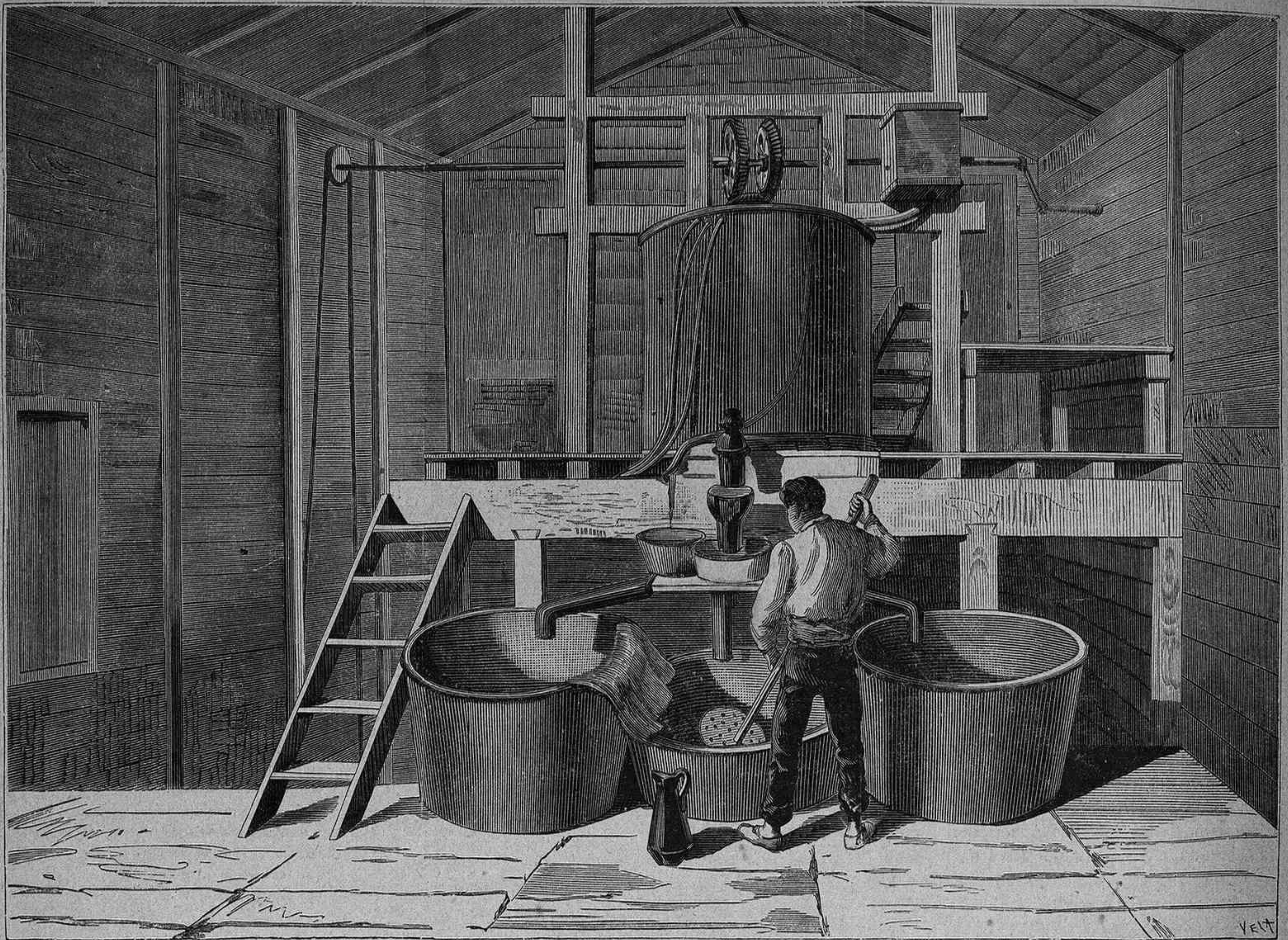
[LA DINAMITA: Extracción y lavado de la nitroglicerina.]
