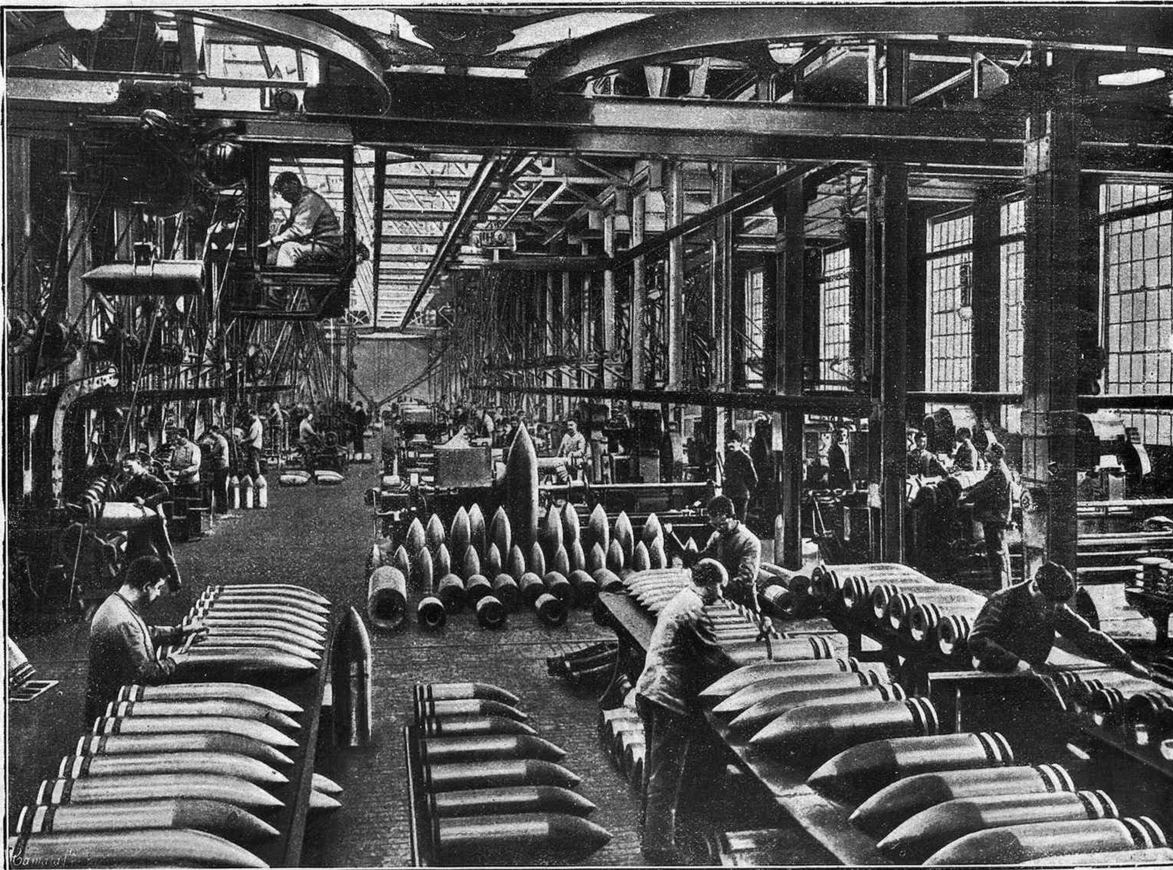
Uno de los talleres más interesantes de la fábrica Krupp Maquinaria para torneear proyectiles
