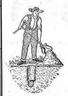
Arados JANUS; Gradas de MUELLES, ZIG-ZAG y ROTATIVAS; Cultivadores AMERICANOS; TRITURADORES de grano; Trillos ROTATIVOS de gran trabajo; HILO DE ABACÁ; MOTORES A GASO-LINA «NEW-WAY» enfriados por aire; BARRENAS PARA TIERRA, hacen hoyos de 20 á 25 centímetros de diámetro y hasta 10 metros de profundidad, propias para plantación, pozos, etc.
