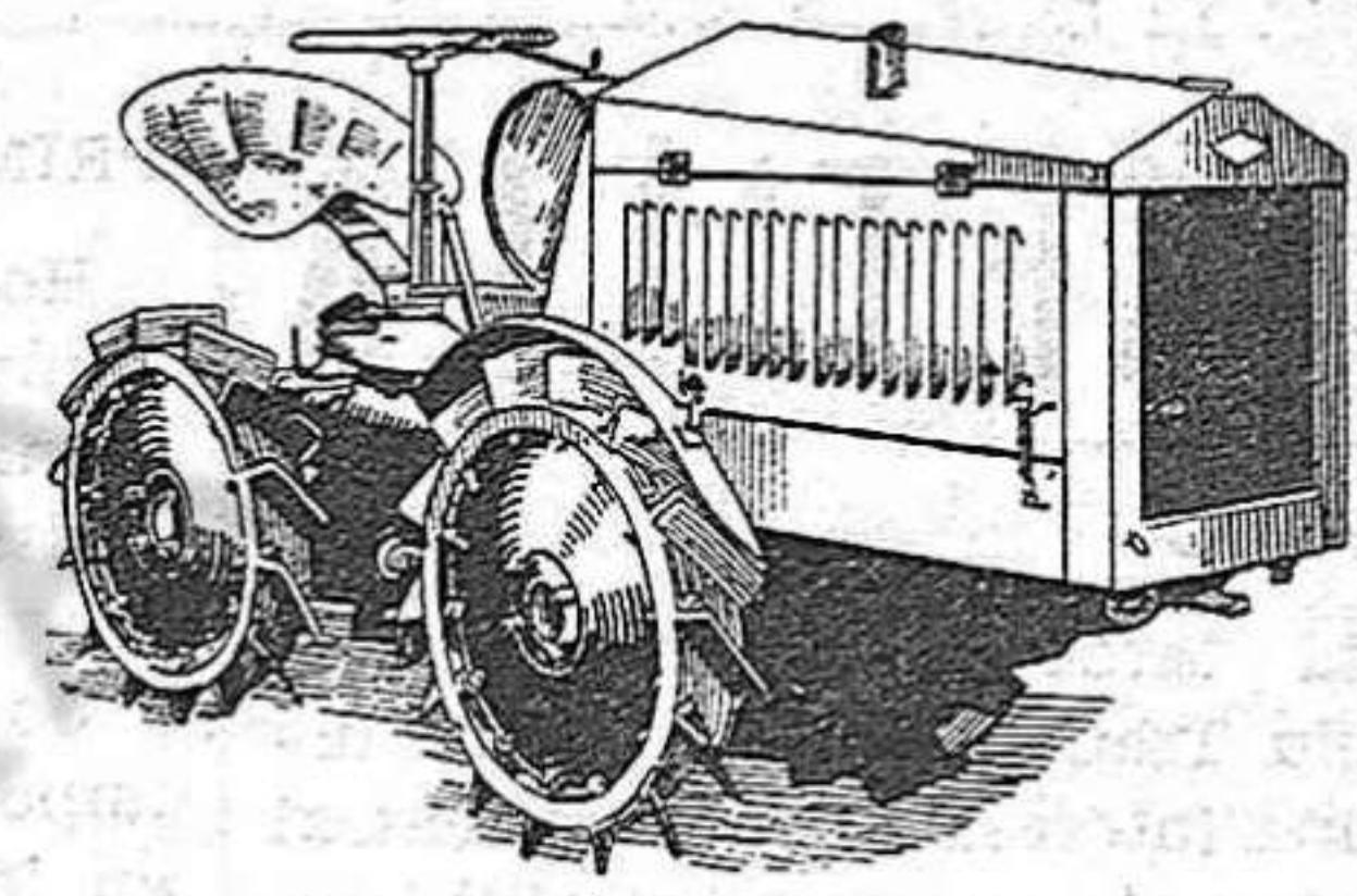
es el ideal para el pequeño cultivo. No patina. Va equipado con MOTOR DE CUATRO CILINDRAS, con una potencia en la barra de tiro de 12 HP. Su anchura de 62 c.m. permite el paso por viñas estrechas y su potencia es ideal para labores diversas.
