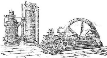
Motor de gas pobre con gasógeno.
