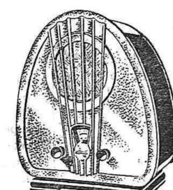
CARACTERÍSTICAS Superinductancia; dos circuitos sintonizados; cinco válvulas; altavoz dinámico; ondas cortas y largas; un solo mando; detección anti-fading; enchufable a la corriente del sector; conexiones para pick-up y altavoz suplementario
