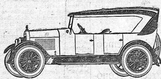
El más moderno, perfecto y económico.—MOTOR seis cilindros 40 HP Aviación.—Engrase perfecto y moderno a presión.—Válvulas en cabeza con mandos engrasados a presión.—Freno hidráulico a presión de aceite en las cuatro ruedas.—Cubiertas BALLON.—Carrocería la más fina y elegante.
