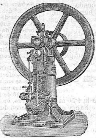
En estos motores se ha suprimido el repartidor efectuándose la entrada de gas y aire por válvula.
