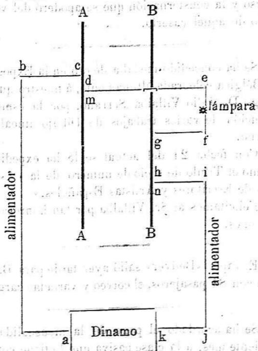
AA y BB. Hilos del circuito principal.—m y n, puntos de amarre de los ramales, a, b, c, d, e, f, g, h, i, j, k indica la marcha de la corriente. Solo se han dibujado dos alimentadores, para mayor sencillez.
