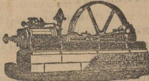
Máquina de vapor fija horizontal
