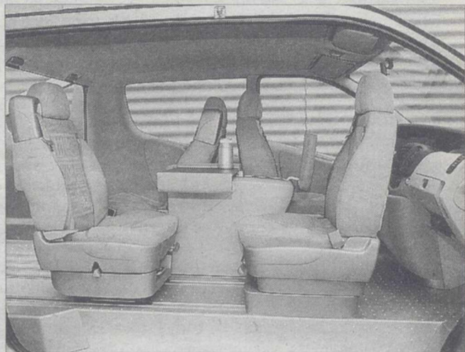
El modelo es el del Renault Trafic. Las puertas laterales se abren asimétricamente. Los asientos pueden ponerse unos frente a otros.
