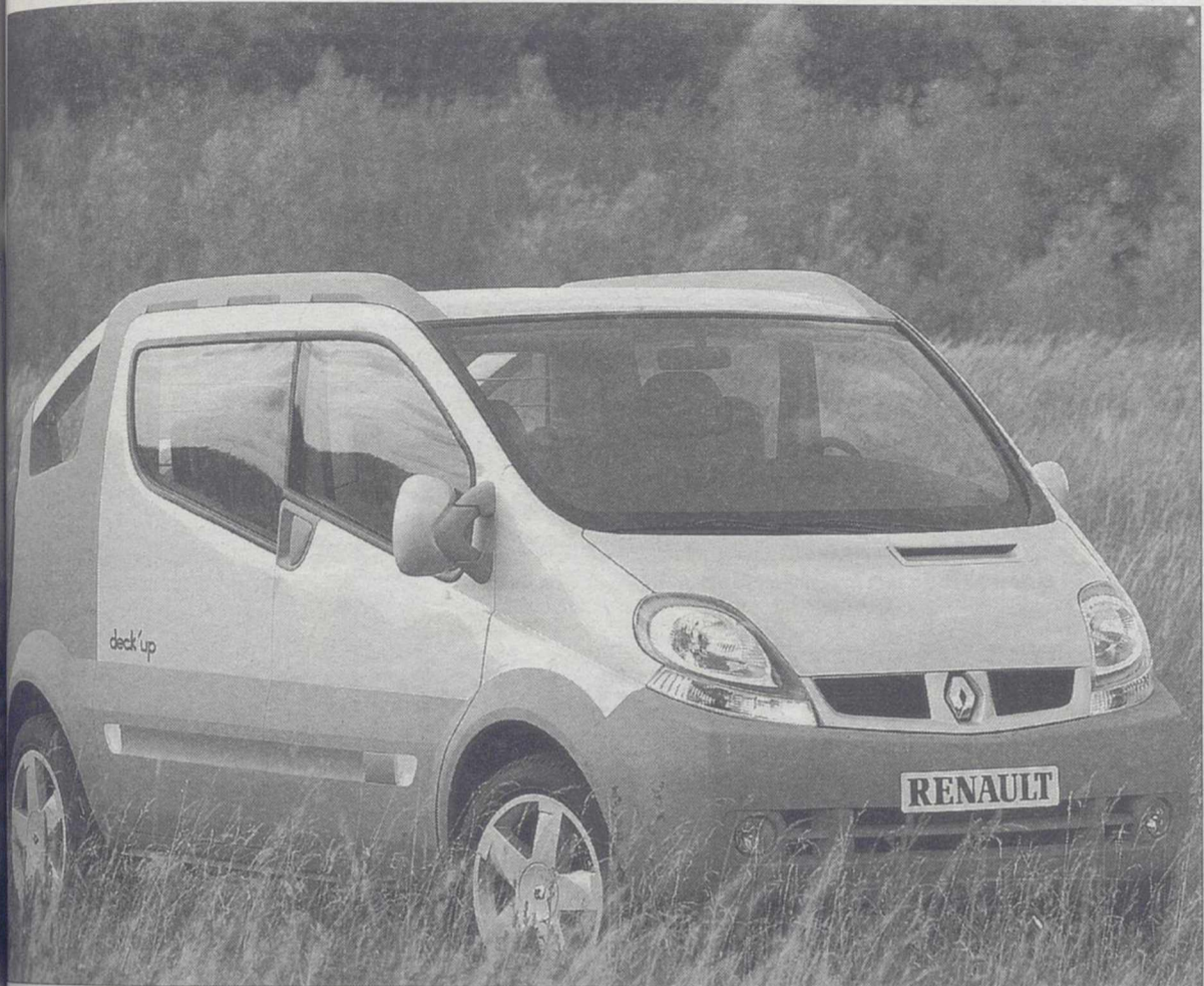
El modelo es el del Renault Trafic. Las puertas laterales se abren asimétricamente. Los asientos pueden ponerse unos frente a otros.
