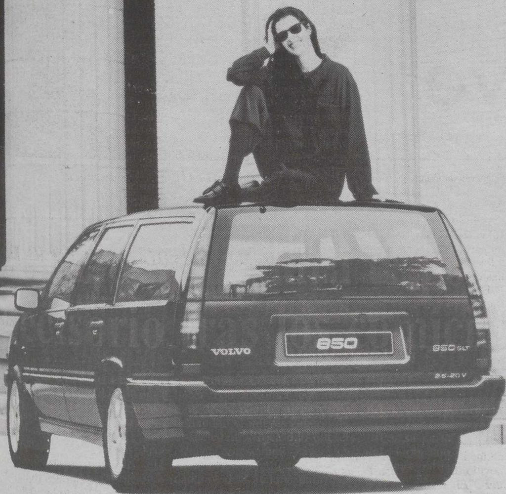
VOLVO 850 GLT. 2,5 L., 5 CILINDROS, 20 VALVULAS. 170 CV. TRACCION DELANTERA, ABS, S.I.P.S. (SISTEMA DE PROTECCION CONTRA IMPACTOS LATERALES), 0 A 100-KM/H. EN 9,5 SEGUNDOS, SUSPENSION DELTA LINK.
