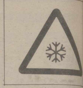
Peligro por la proximidad de calzada con pavimento deslizante por hielo o nieve.
