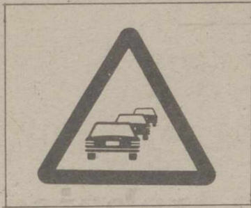
Peligro por la proximidad de un tramo en el que la circulación está dificultada por congestión.
