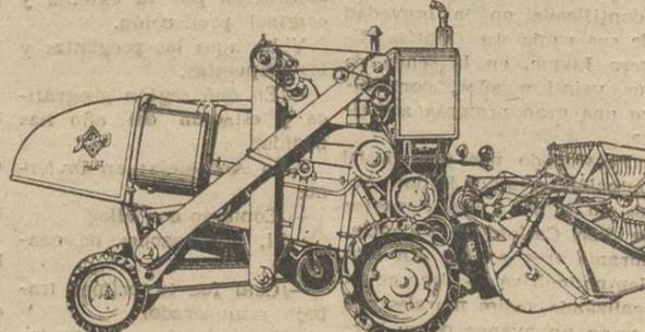
Cosechadoras automotrices Mod. «JUBUS-Clipper» S. 220 y S 255 equipadas con motor Diesel «Perkins» de 45 y 52 CV. Anchuras de corte 2'20 y 2'55 mts.
