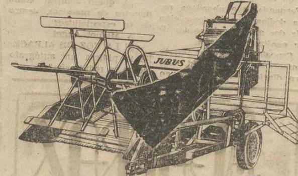
Cosechadoras de arrastre con toma de fuerza o motor auxiliar «JUBUS» CJ 150 y CJ 180 Anchuras de corte 1'50 1'80 mts.
