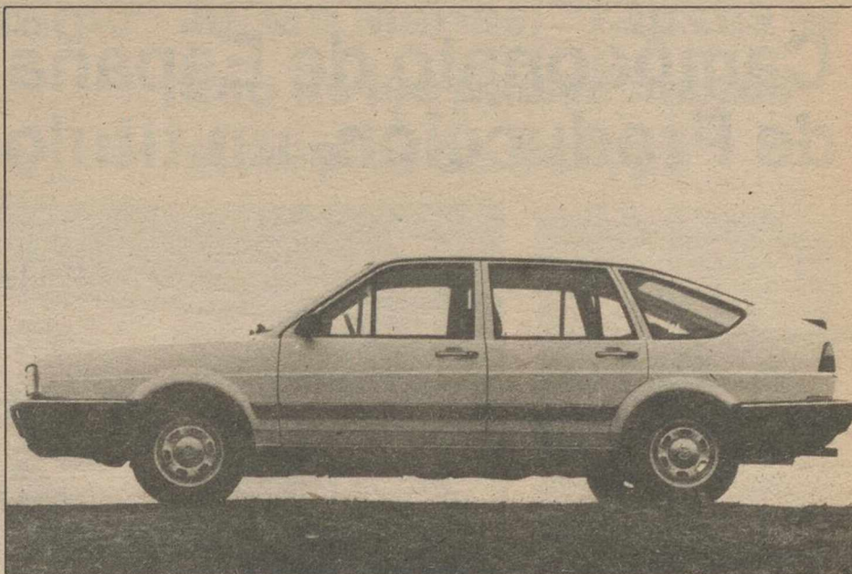
Entre las nuevas aportaciones destaca la luneta posterior, de mayores dimensiones y que llega a los mismos bordes el portón, y el spoiler situado en la base de la misma.
