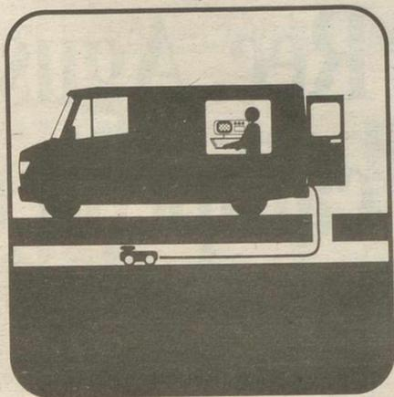
Revisión de tuberías con equipos de TV.
