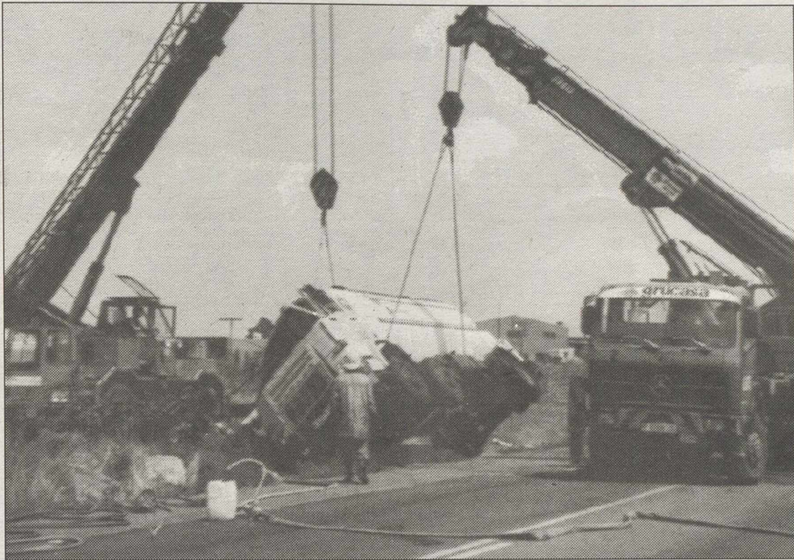
Dos grúas de Manzanera proceden a levantar el camión cisterna cargado con 3.500 litros de propano.
