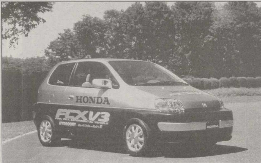
Aspecto exterior del FCX-V3 a base de pila de combustible de hidrógeno.
