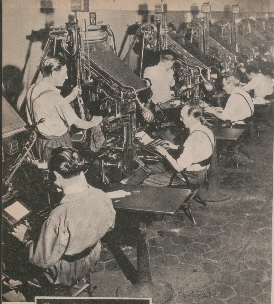
Unas catorce mil líneas de texto lleva cada número de EL ESPAÑOL. Estas máquinas son las encargadas de componerlas
