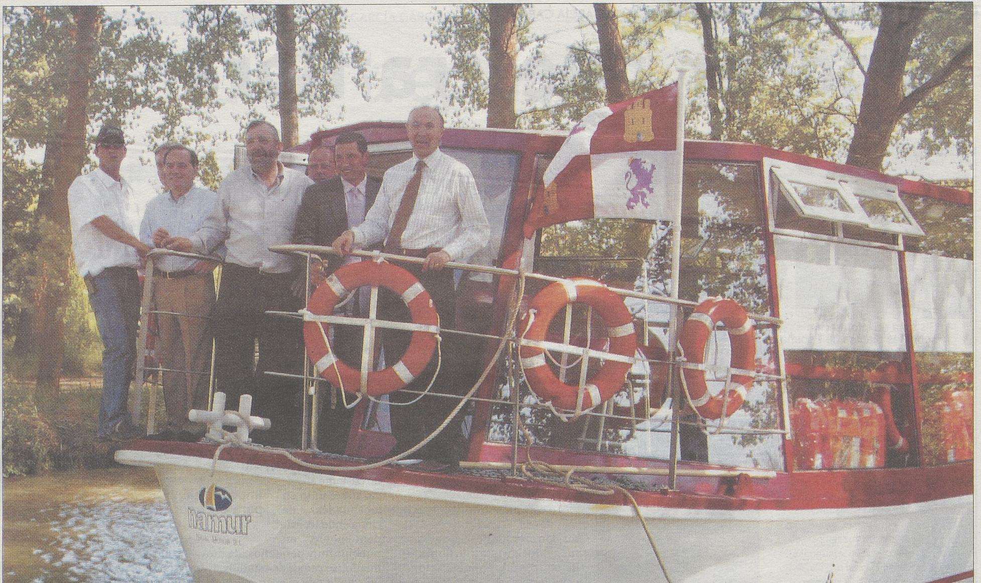
La embarcación, de 19,3 metros de eslora, se impulsa con dos motores eléctricos, cuenta con 52 plazas y está cubierta por una cristalera que permite contemplar el paisaje. / C. CALVO (ICAL)
