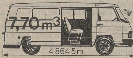
chasis tubular soporta una carrocería de 4,86 m con una distancia entre ejes de 2,75 m para disponer de mayor superficie de carga, y por lo tanto de mayor volumen, hasta un máximo de 9,6 m³ en la versión de techo elevado.
