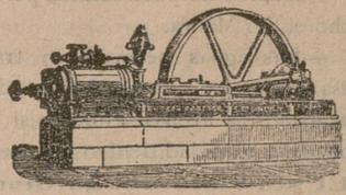
Máquina de vapor fija horizontal
