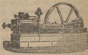
Máquina de vapor fija horizontal
